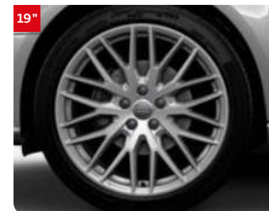
Jantes en aluminium coulé en style 10 branches en Y Pneus : 235/35 R 19 Code : 49K
